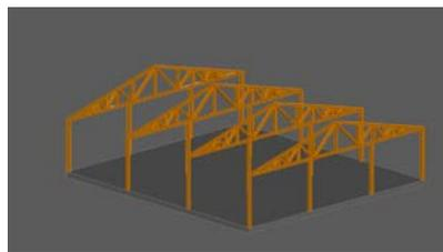
**3** Instale las correas de madera distanciada entre si, según lo recomendado en la ficha técnica de la **plancha Fibraforte traslucida onda 76**
