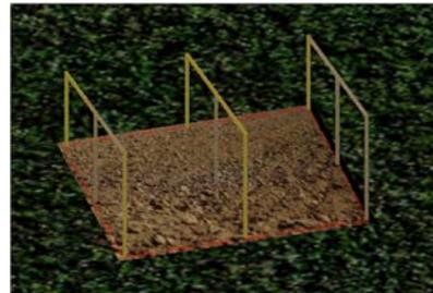
**3** Instale las correas de madera distanciada entre si , según lo recomendado en la ficha técnica de la **plancha Fibraforte traslúcida onda 76**
