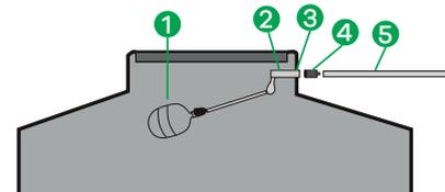
Su nuevo tanque cuenta con una base especial que permite la colocación de un control de nivel automático o electrónico.
