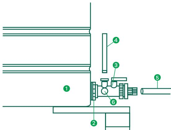
Su tanque (1) cuenta con una brida (2) roscada. Enrosque el multiconector (3) con salida de 3/4" ó 1". Utilice la que corresponda al diámetro de su tubo de distribución (5). Para ajustar el multiconector utilice solamente las manos. Gire hasta que el tubo o visor de agua (4) queden hacia arriba y el tapón de limpieza (6) quede a un lado como se muestra en la figura. Conecte al Multiconector (3) a la tubería de distribución (5).
