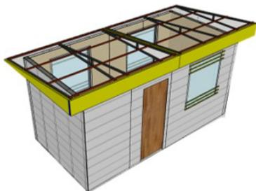
**4** Por último colocar las Planchas FIBRAFORTE OPACAS con la estructura del techo, y dar los últimos detalles como colocar ventanas con Plastiglass FIBRAFORTE y puertas contraplacadas.
